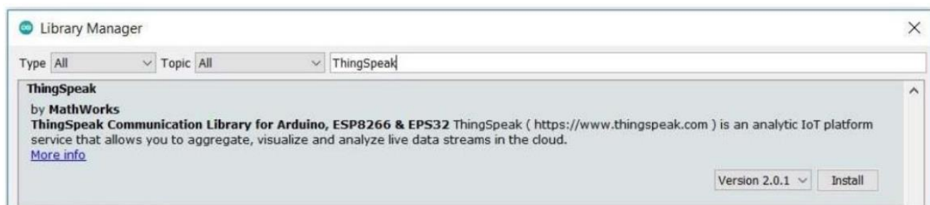
Рисунок 3.30 – Інтеграція бібліотеки ThingSpeak для налаштування передачі даних у мікроконтролері ESP32 [46]
