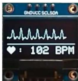
Рисунок 3.14 – Відображення на OLED-дисплеї даних щодо частоти серцевого ритму [45].
