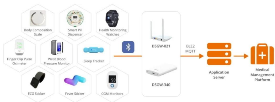
Рисунок 2.1 – Архітектура віддаленого медичного моніторингу із застосуванням IoT-технологій [24]
