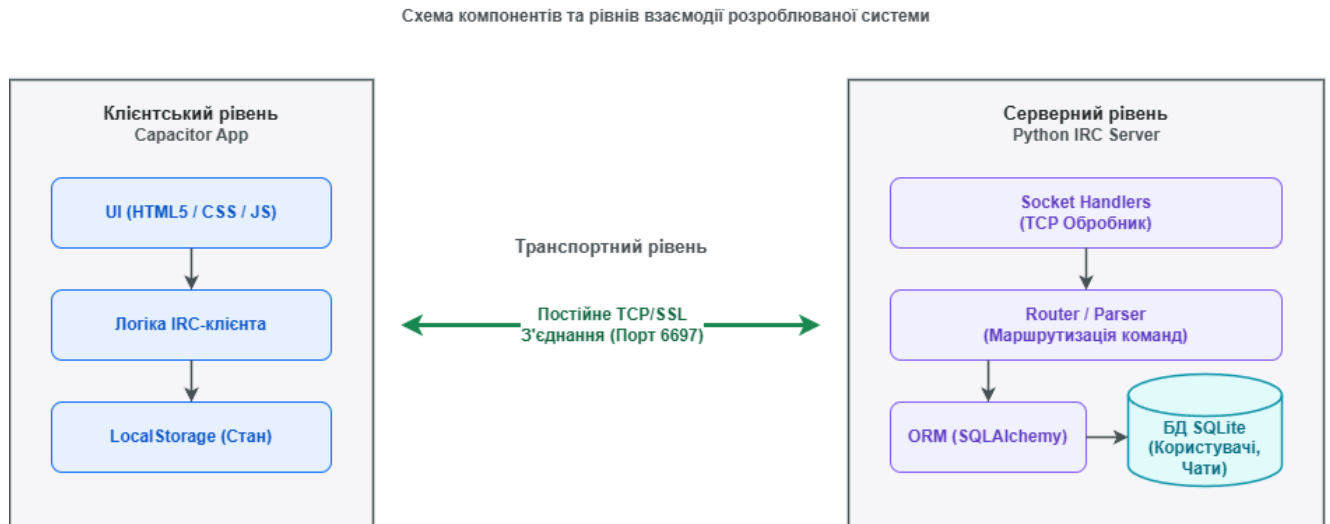
Рис. 2.3 - Логічна архітектура клієнт-серверної взаємодії
