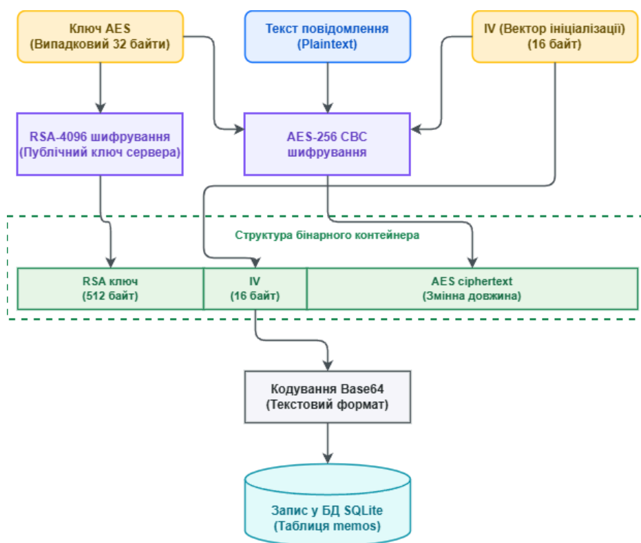
Рис. 2.8 - Концептуальна схема формування зашифрованого контейнера відкладених повідомлень
