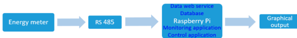
Рис.1.7 Принципова блок-схема системи моніторингу енергії Інтернету речей
