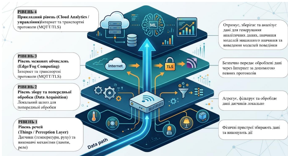
Рис. 1.1 – Ієрархічна архітектура системи «розумного будинку» з елементами аналітики
