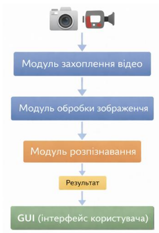
Рис. 2.1 – Функціональна структура програмного застосунку
