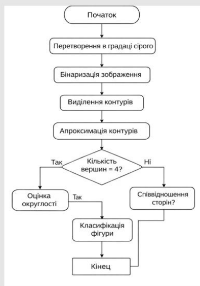
Рисунок 5 – Схематичне представлення алгоритму визначення геометричних фігур
