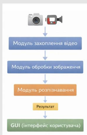
Рисунок 3 – Функціональна структура програмного застосунку
