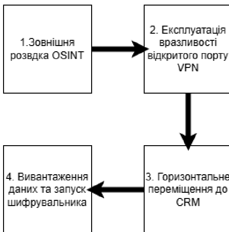
Рисунок 2.2 – Моделювання етапів цілеспрямованої кібератаки на традиційну периметральну мережу
