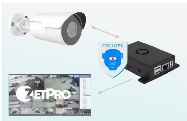
Рис 2.1 Гібридна архітектура системи контролю доступу на базі LPR BOX «Cyclops» з передачею метаданих на сервер VMS
