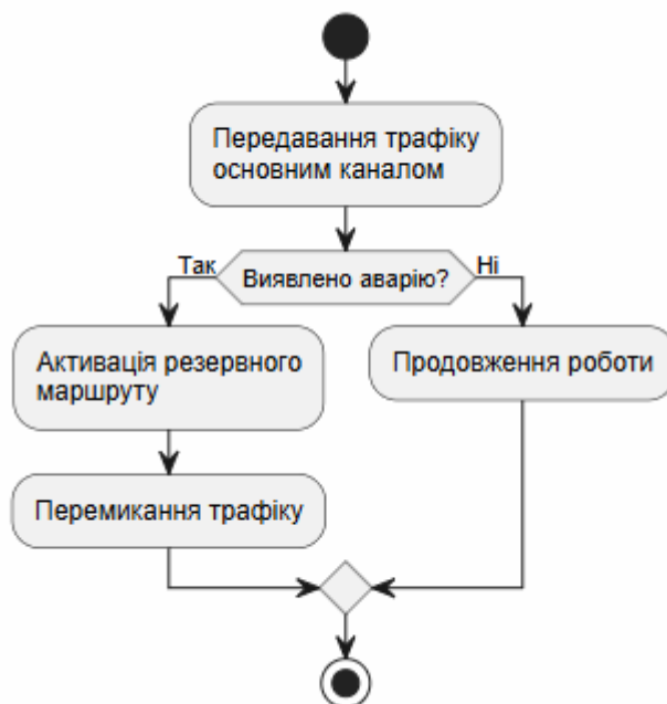
Рисунок 1.8 демонструє загальний алгоритм автоматичного перемикання трафіку
