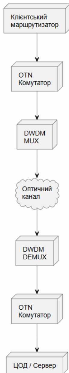
Рисунок 2.2 Принцип взаємодії компонентів транспортної мережі OTN
