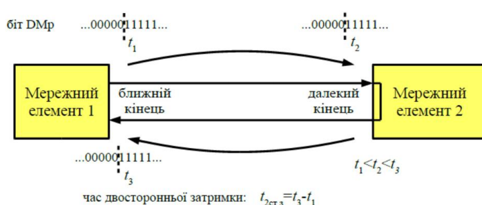
Рисунок 2.5 – Ілюстрація принципу вимірювання затримки в тракті ODUk за сигналом DMP
