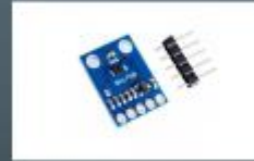
BH1750 Цифровий датчик освітленості, блокує вмикання вдень
