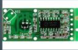
RCWL-0516 Мікрохвильовий доплерівський радар, проникає крізь пластик корпусу
