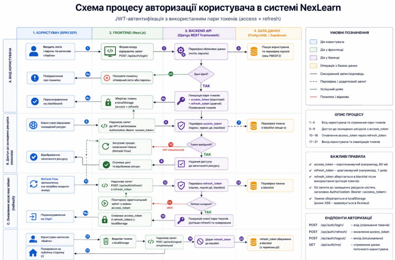
Рис. 2.12. Схема процесу авторизації користувача
