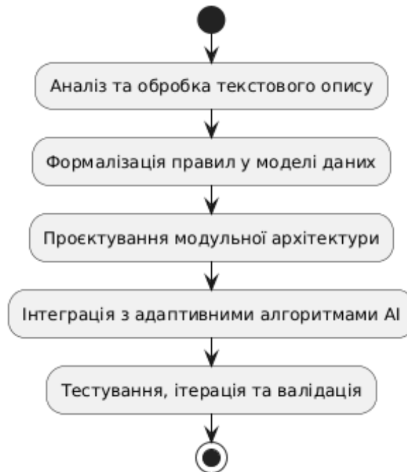
Рис. 1.3. Схема послідовності етапів методики проектування системи на основі обробки текстового опису правил
