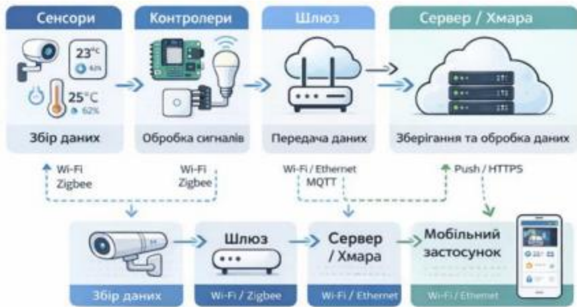
Рисунок 1.7 – Структурна схема логіки взаємодії компонентів та потоків даних у системі IoT
