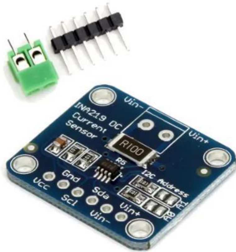
Рисунок 2.3 – Цифровий сенсор INA219 для комплексного моніторингу струму та напруги
