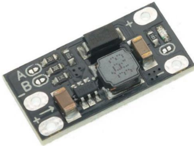
Рисунок 2.4 – Електронний DC-DC перетворювач для підвищення та стабілізації напруги
