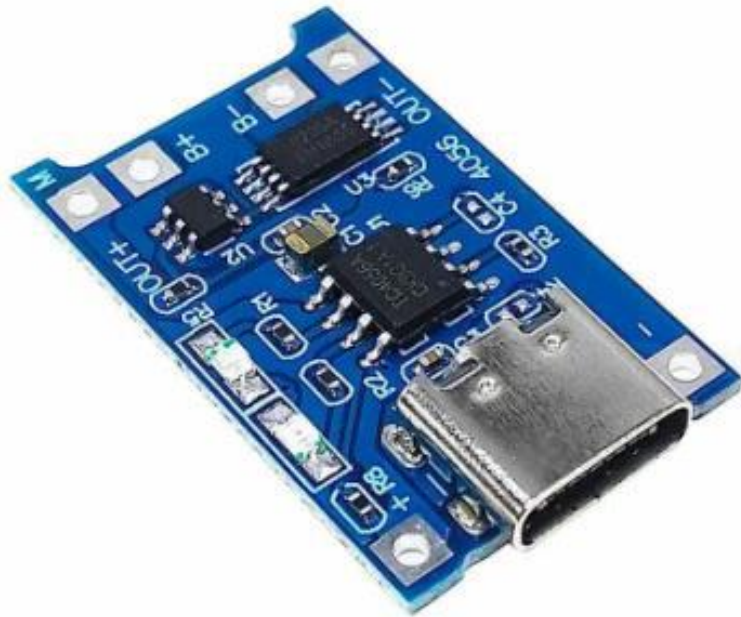
Рисунок 2.2 – Модуль TP4056 для безпечного керування процесами заряду та розряду
