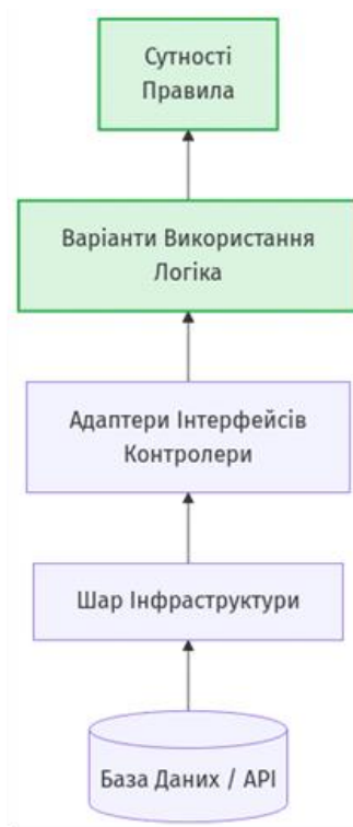
Рис. 1.1 Топологія та взаємодія компонентів у монолітній архітектурній моделі
