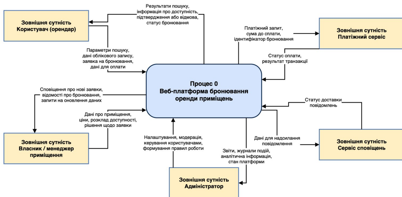
Рис.1.1.Контекстна діаграма потоків даних веб-платформи бронювання оренди приміщень
