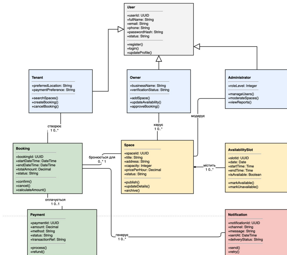
Рис.2.5.UML-діаграма класів веб-платформи бронювання оренди приміщень
