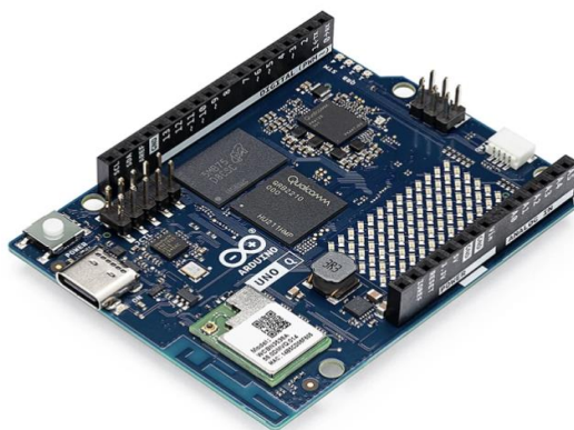
Рис. 1.6 Плата Arduino UNO Q як приклад відкритої IoT-платформи
