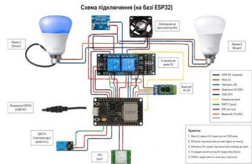
Рис.24. Схема-прототип: ESP32, Arduino, релейний модуль, датчики та лампи (фізична схема)
