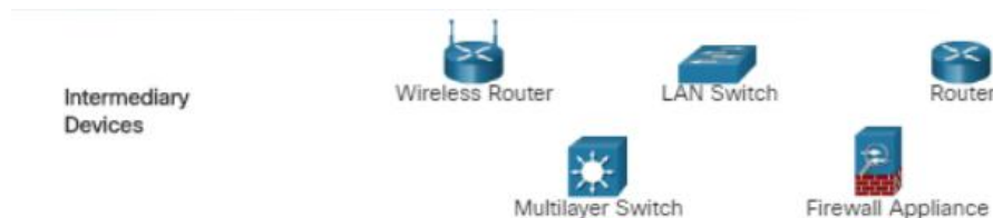
Рисунок 2.2. Проміжні мережеві пристрої: комутатор, точка доступу, маршрутизатор, міжмережевий екран (пристрої безпеки)
