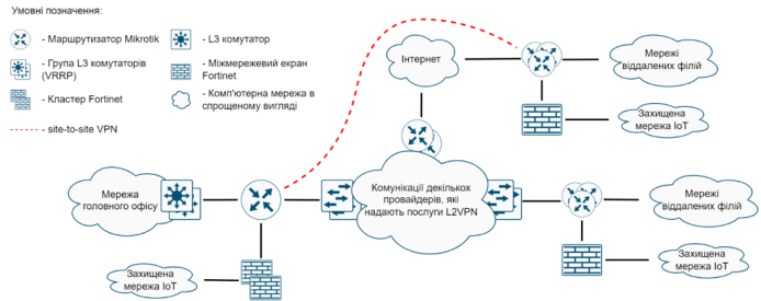
Рисунок 5– Частина плану IP-адресації (провайдерські підключення та VLAN-сегменти)
