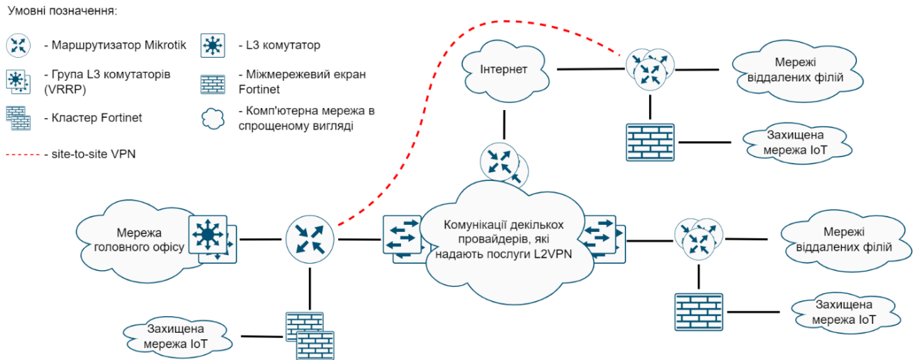
Рис. 2.2 – Структурна схема мережевої архітектури прототипу
