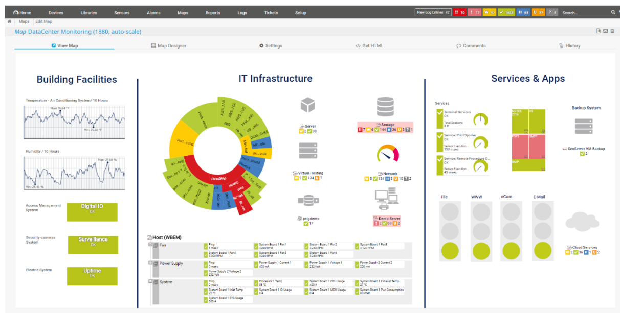
Рис. 1.9 Приклад інтерфейсу Paessler PRTG Network Monitor із температурними сенсорами та аварійними сповіщеннями [8]
