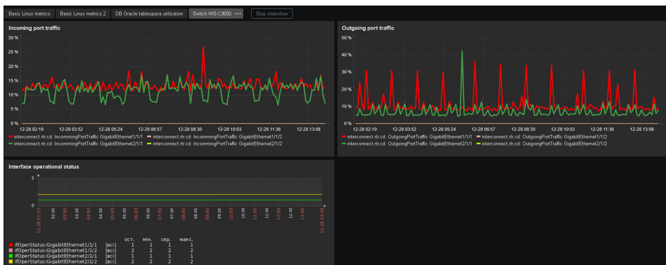
Рис. 3.5 Вкладка №4 з метриками трафіку та станом портів комутатора
