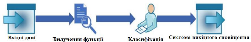
Рис.2.2 Основний процес алгоритму машинного навчання, навченого за допомогою даних IoT для виявлення аномалії
