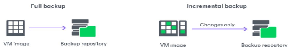
Рисунок 2.7 Як працює інкрементальне резервне копіювання в Veeam
