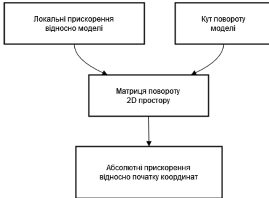
Рис. 3.17 Схема перетворення координат з локальних в глобальні
