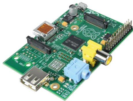
Рис.1.2 Мікропроцесорна система Raspberry Pi
