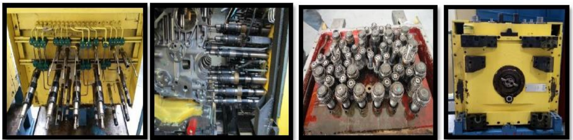
Рис.2.7 Багатошпиндельне обробне обладнання (внутрішній і зовнішній вигляд)
