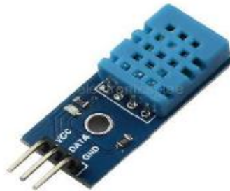
Рис. 2.5 Приклад сенсора для вимірювання вологості
