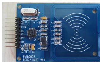
Рис.2.9 Приклад датчиків які виконують читання карток
