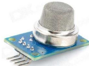
Рис.2.7 Приклад сенсорного пристрою для газу
