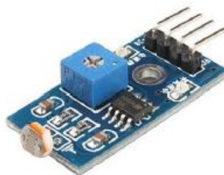
Рис. 2.3 Приклад датчика для освітлення
