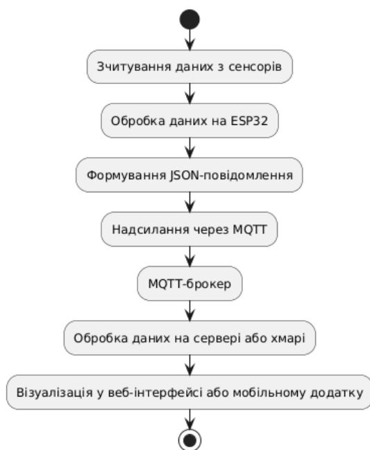
Рис. 3.9 Схема передачі даних від сенсорів до інтерфейсу користувача
