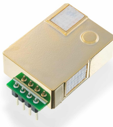
Рис. 1.6 Сенсор МН-Z19 для моніторингу концентрації вуглекислого газу ( \text{CO}_2 )
