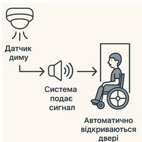
Рис. 2.2 Сигнал тривоги та автоматичне відкривання дверей
