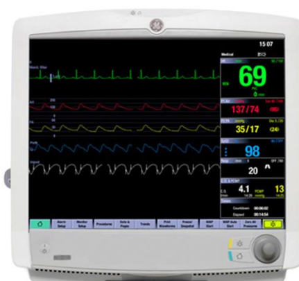
Рис. 1.13 Інтерфейс монітора GE CARESCAPE B650 з візуалізацією кривих ЕКГ, дихання, SpO 2 , артеріального тиску та панеллю керування параметрами [14]
