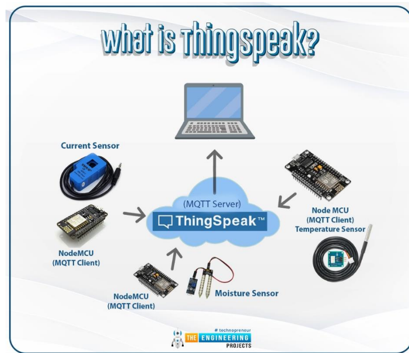
Рис. 2.6 Схема інтеграції сенсорних пристроїв з хмарною платформою ThingSpeak у режимі MQTT-клієнтів [23]
