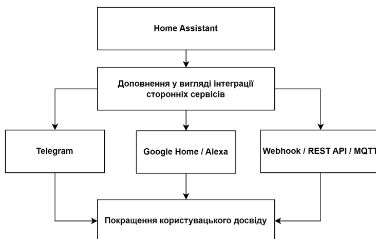
Рисунок 3.3 – Схема інтеграції з Telegram та Google Home
