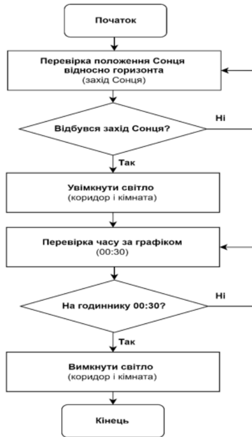
Рис. 2.22 – Алгоритм автоматизації освітлення у вечірній та нічний час
