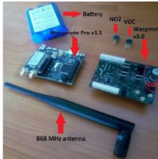
Рис. 1.6. Компоненти пристрою моніторингу якості повітря [6]
