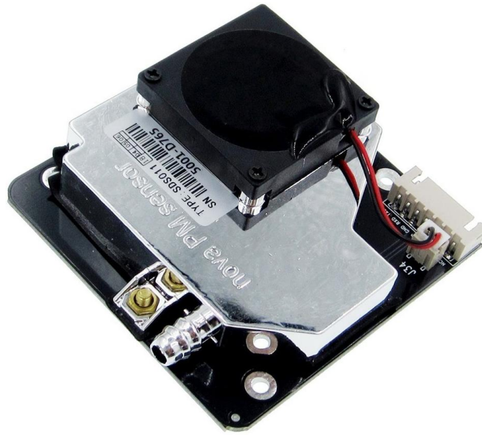
Рис. 2.5. Датчик пилу SDS011[21]
