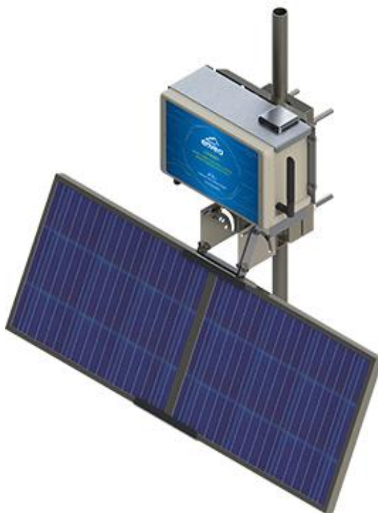
Рис. 1.18. Індикативна станція моніторингу атмосферного повітря ENVEA Cairnet V3 [11]
