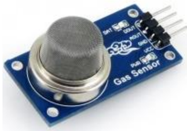
Рис. 2.7. Газовий датчик MQ-135 [22]
