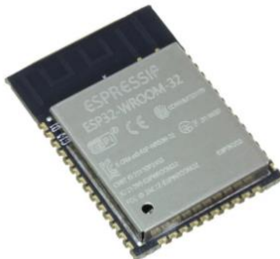
Рисунок 2.5 - Модуль WIFI ESP32-WROOM-32
