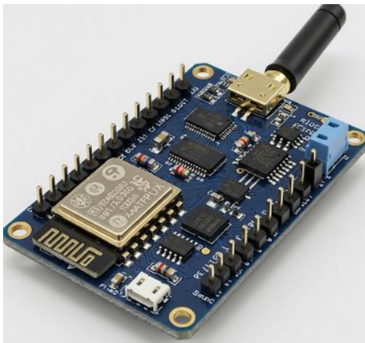
Рисунок 2.4 - ESP8266 плата розробки
