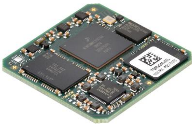
Рис. 2.3 Зовнішній вигляд та специфікація ARM Cortex-A53 [29]
