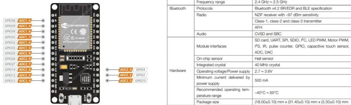
Рис. 2.6 Зовнішній вигляд та специфікація ESP32 [32]
