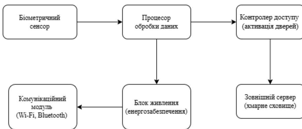
Рис. 2.9 Схема взаємодії компонентів інтеграції біометричних сенсорів у систему контролю доступу
