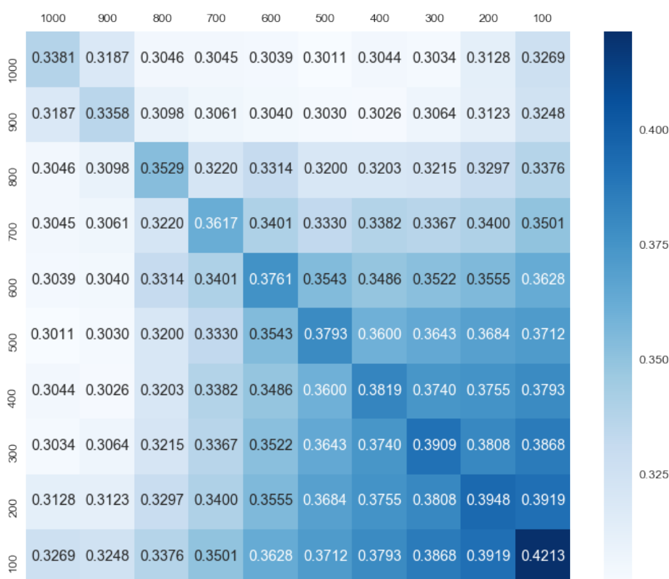
Рис. 3.22 - Матриця, що представляє середні результати валідації MAE для кожної простої мережі енкодер-декодер, навченої з кожною можливою комбінацією двох геопотенційних рівнів.
