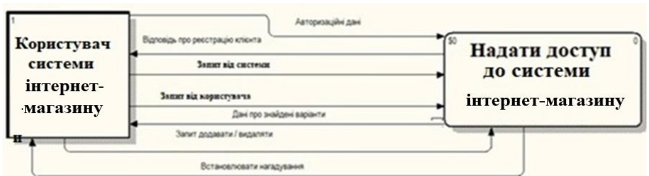
Рис. 3.5. Діаграма потоків даних нульового рівня для веб-проєкту інтернет-магазину
