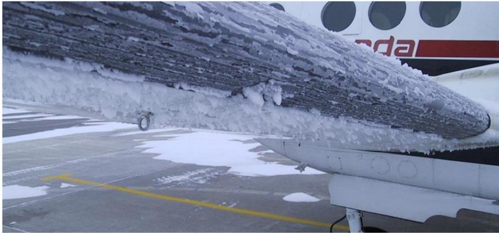
Рис. 1.1. Обмерзання на крилі літака
