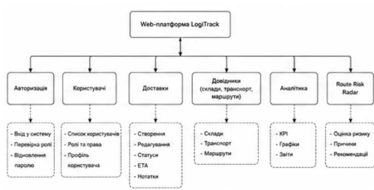
Рис. 4.7 Структура основних модулів платформи LogiTrack
