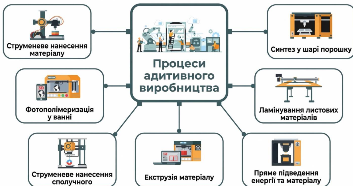
Рис. 1.1 Загальна схема основних процесів адитивного виробництва
