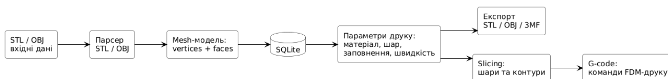
Рис. 3.10 Схема імпорту, експорту та генерації G-code у мобільному застосунку
