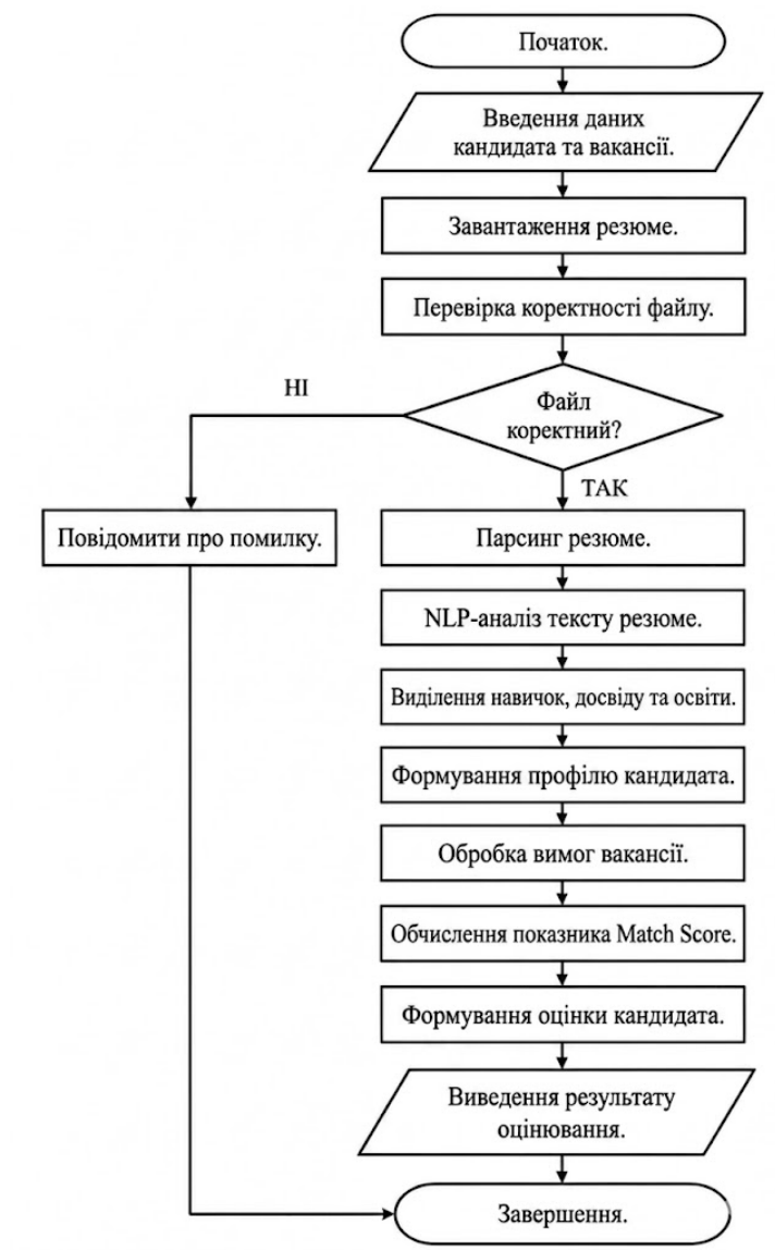
Рис. 2.10 Блок-схема алгоритму автоматизованого оцінювання кандидата
