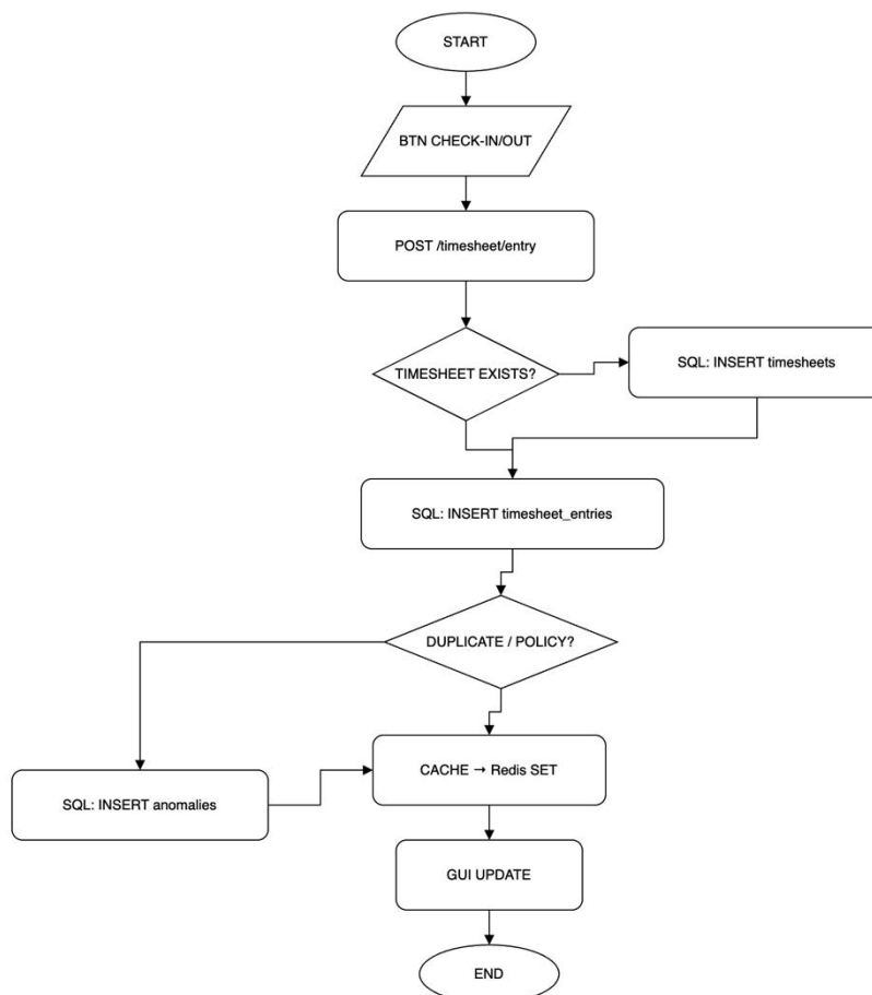
Рис. 3.11 – Блок-схема алгоритму Check-in / Check-out
