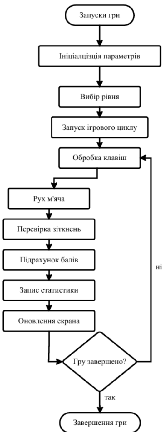
Рис. 2.4 Алгоритм роботи ігрового циклу
