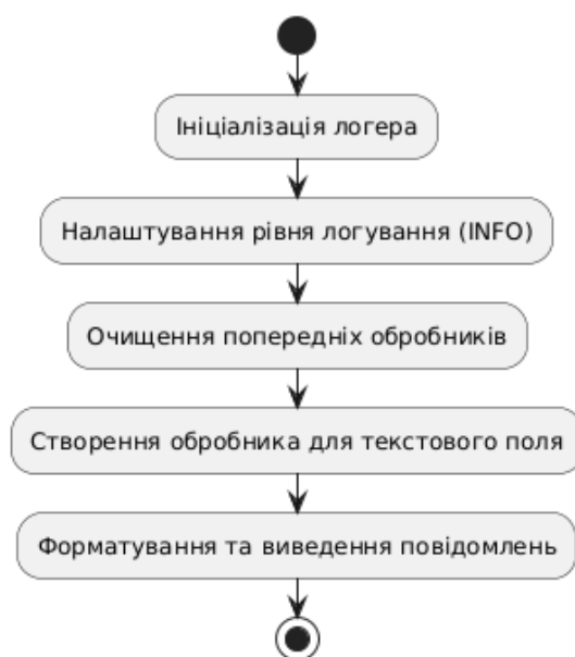
Рис. 2.6 Блок-схема модулю для введення логів
