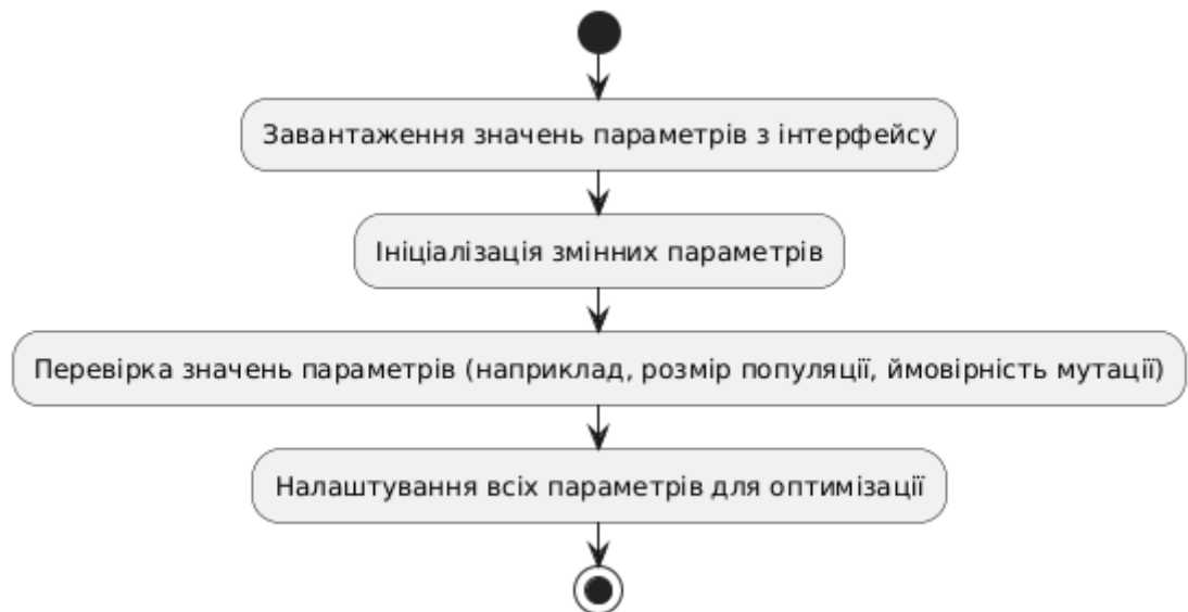
Рис. 2.9 Блок-схема ініціалізації параметрів
