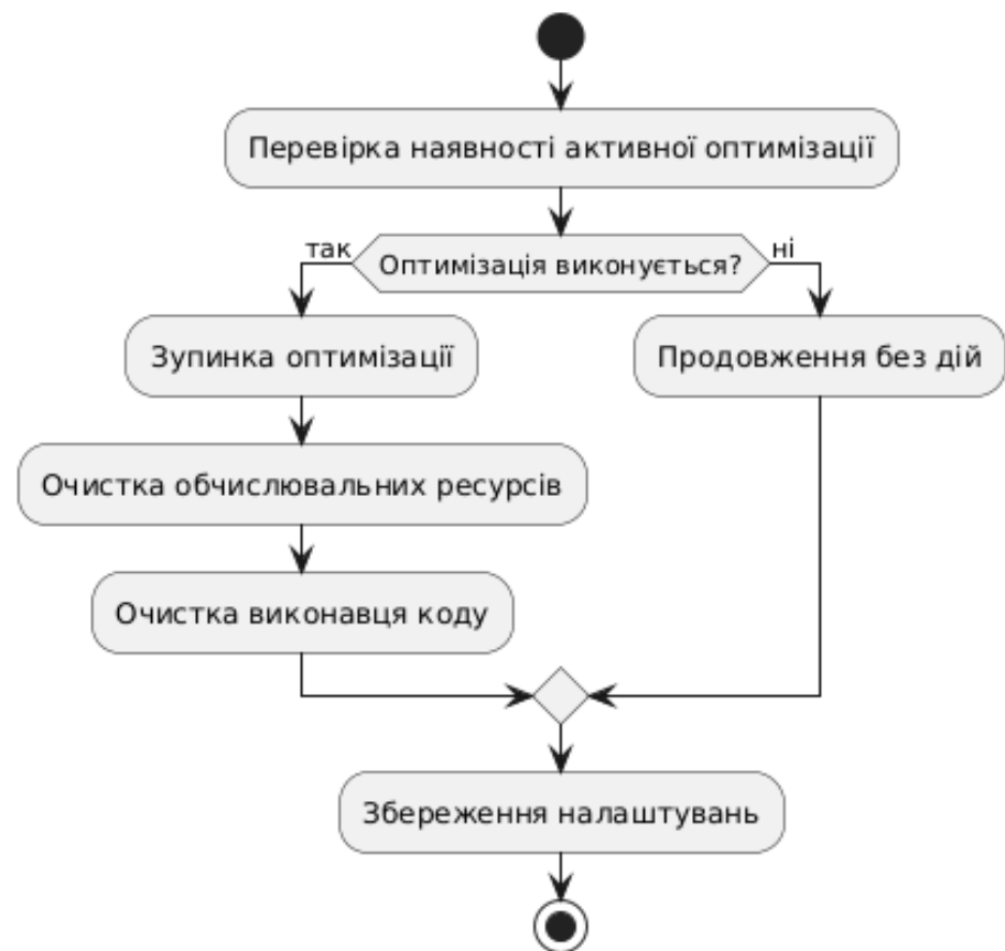
Рис. 2.7 Блок-схема механізму очищення ресурсів
