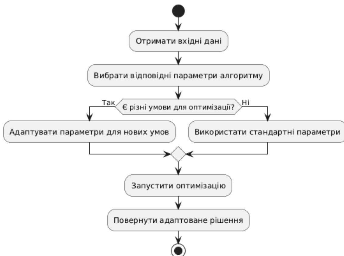
Рис. 4.5 Блок-схема підтримки гнучкості та адаптивності
