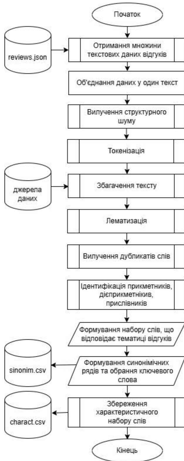
Рис. 2.17 Блок-схема узагальненого алгоритму побудови множини базових слів
