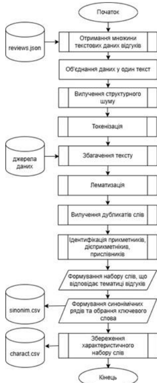
Узагальнена блок-схема алгоритму побудови базового набору слів
