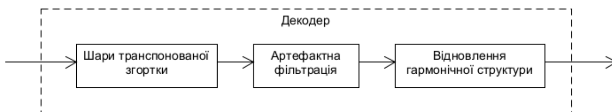
Рис. 3.3 Модифікований денкодер трансформера для мультиголосового поділу
