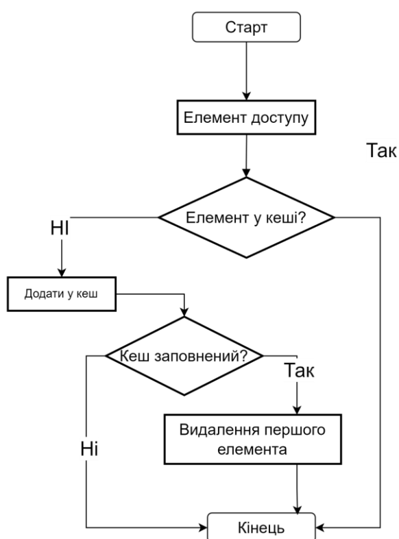
Рис. 1.5. Блок-схема алгоритму FIFO
