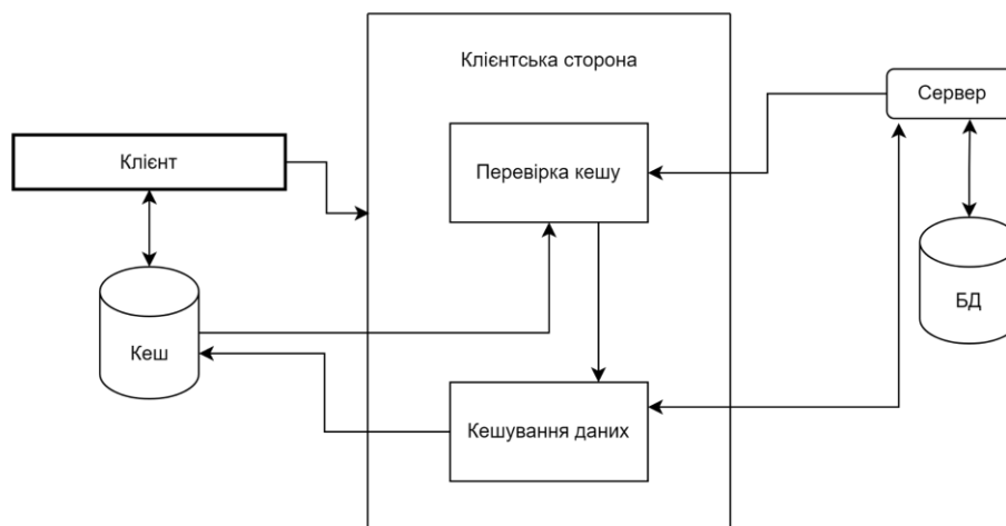
Рис. 1.1. Схема кешування на стороні клієнта
