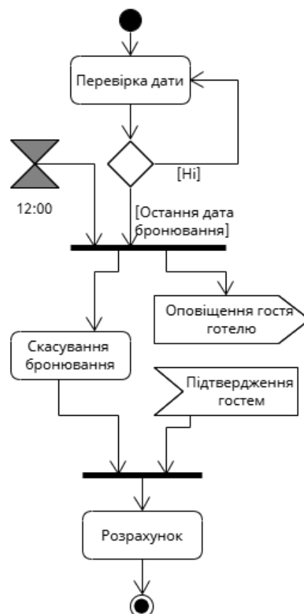
Рис. 4.13 UML-діаграма активності обробки прострочених бронювань
