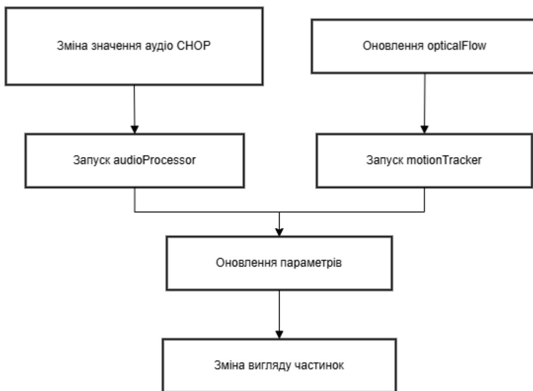
Рис. 3.6 Принципова схема активації скриптів за подією
