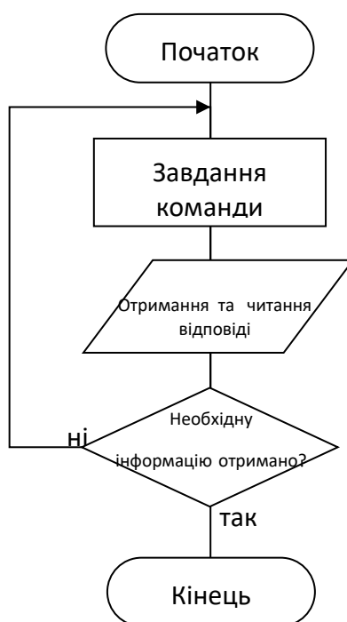
Рис. 2.2 Блок-схема алгоритму роботи веб-додатку, що надає інформацію про погодні умови
